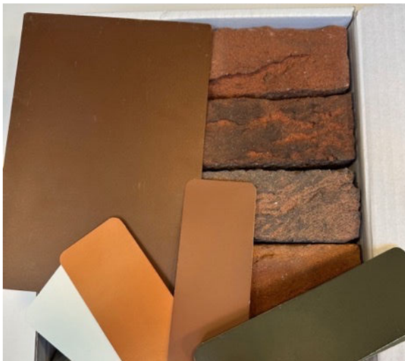
Kleur gevelkozijnen en roldeur RAL 8002.
